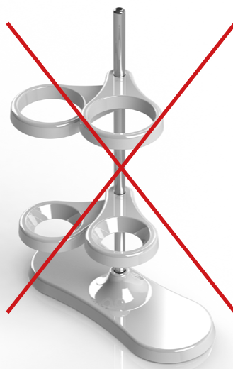
Position incorrecte des supports d'entonnoirs - risque de basculement!
