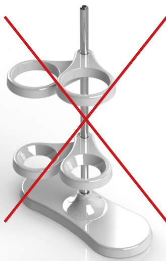
Неправильное положение держателей воронок - опасность опрокидывания!
