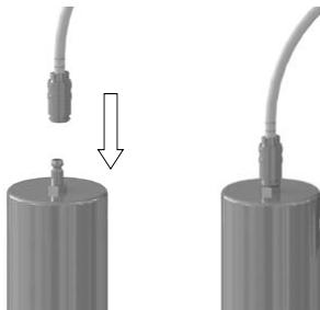
6. Снимите погружную трубку с помощью быстроразъемного соединения с погружного цилиндра.
